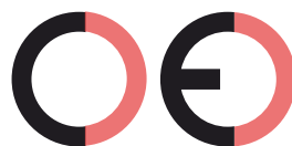
Faux marquage CE (trop éloignée)
